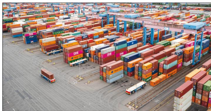
Ein „Automated Guided Vehicle“, kurz AGV, bringt auf dem Container Terminal Altenwerder im Hamburger Hafen einen Container zu einem Blocklager mit Portalkränen (Rail Mounted Gantry Crane oder RMG genannt). Die deutsche Wirtschaft ist nach dem coronabedingten Absturz im Frühjahr im dritten Quartal wieder in Schwung gekommen. Foto: dpa
